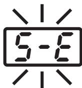
В случае возможной неисправности датчика или нагревателя (включая цепь датчика), на дисплее отображается надпись **5-E**, а питание станции отключается.
