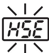
При попадании посторонних предметов в соединитель, вставке несовместимой головки или неправильной вставке головки в паяльник НАККО FM-2028 на дисплее будет мигать надпись **HSE**, и будет раздаваться непрерывный звуковой сигнал.
