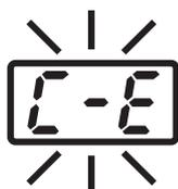
В случае, если соединительный кабель не подключен к станции или подключен несовместимый паяльник, на дисплее будет мигать надпись **L-E**.
