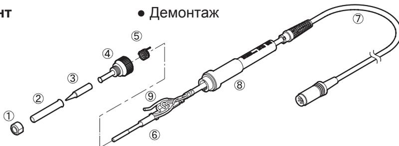
1. Отвернув гайку (1) против часовой стрелки, удалите гильзу наконечника (2) и наконечник (3).
