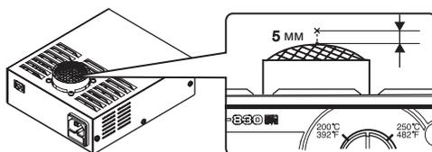
**⚠ ВНИМАНИЕ:** если ручка температуры стоит на отметке 150 °C, установка отрицательного (-) смещения невозможна. Если ручка регулировки температуры стоит на отметке 300 °C, установка положительного (+) смещения невозможна.
