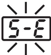
Это сообщение появляется при возможной неисправности датчика температуры (или цепи датчика). В этом случае на индикаторе мигает надпись **S-E**, а питание прибора отключается.
