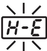
Это сообщение появляется, когда температура горячего воздуха падает даже при включенном нагревателе. На индикаторе мигает надпись **H-E**, сигнализирующая о возможной неисправности нагревателя.
