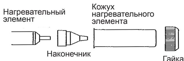
Отверните гайку прилагаемым ключом
